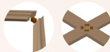
Les raccords de parclozes à coupe d'onglet sont assemblés en queue d'aronde afin d'éviter l'ouverture des coupes.
